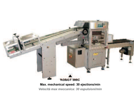
Shuttle Feeder Sfilatore First Page Opener Apertura Prima Pagina Sheet Feeder Mettifoglio Side Sealer Saldatore Laterale Film Stretching Rollers Rulli Stiro del Film Patented Longitudinal Sealer Saldatore Longitudinale Brevetato Cross Sealer Saldatore Trasversale Motorized External Spool Unwinder Sbobinatore Esterno Motorizzato Touch Only Control Panel Pannello di Controllo Touch Screen
